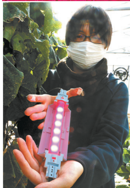
赤色LED防除装置の照射部分。ハウス内の日陰で撮影。
