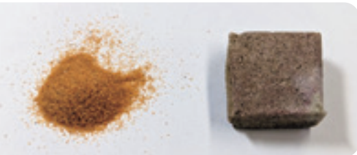
ナミブ砂漠の砂から製造した硬化体
